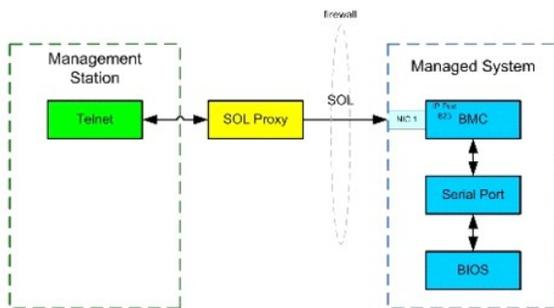
Le schéma de configuration du serveur proxy SOL vous permet d'afficher et de configurer les paramètres BIOS d'un système géré, ainsi que de réinitialiser le système géré à distance à l'aide du client telnet. Le serveur proxy SOL est installé comme service de démon et démarre automatiquement à chaque fois que le système démarre. Le serveur proxy SOL ne peut prendre en charge qu'une session telnet à la fois.
